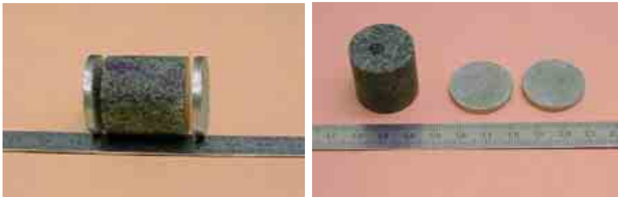
Figure III-9 : Echantillon et pastilles de billes d'acier frittées (volume poreux 550 \text{ mm}^3 ).
