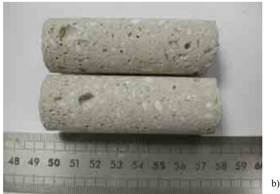
Figure IV-15 : a) bloc de mortier micro poreux, b) carottes prélevées dans le bloc, montrant des éléments minéraux et des cavités millimétriques.
