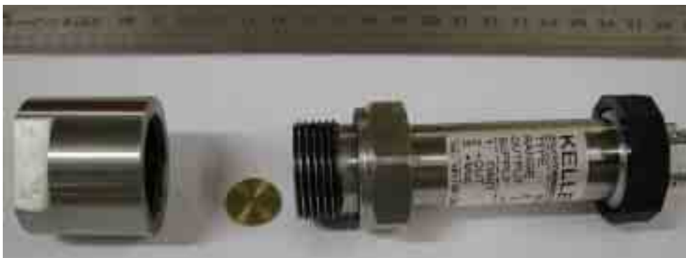
Figure III-7 : Raccord usiné et capteur de pression Keller type PA-25 / 8735.1-1000, à membrane affleurante, auquel on ajoute une pastille de laiton afin de limiter au maximum les volumes morts.
