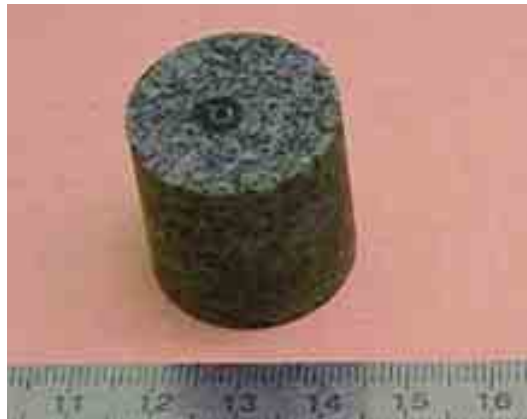
Figure IV-8 : Echantillon du granite de Westerly
